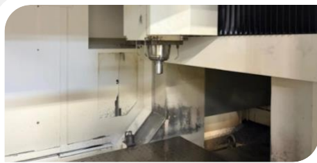
3-axis DMG DMC 100 Hi-dyn XYZ 1000 x 800 x 500 mm, SK40, CTS
